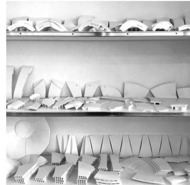
3D-Drucke der Schalungselemente im Maßstab 1:50 © HTWG Konstanz
