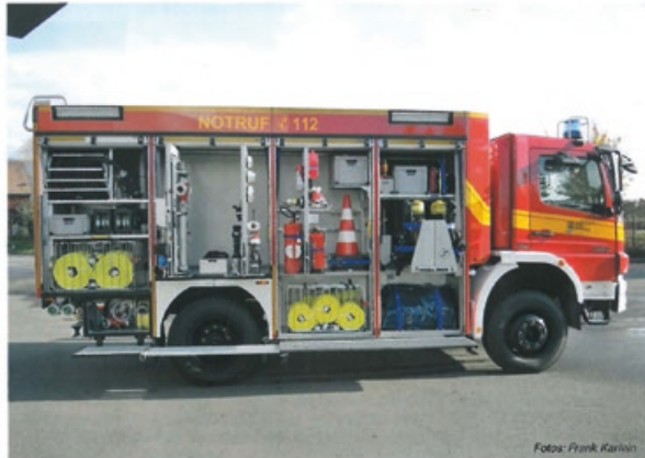
Auf Auszügen sind die am meisten benötigten Gerätschaften übersichtlich und zum schnellen Zugriff verlastet
