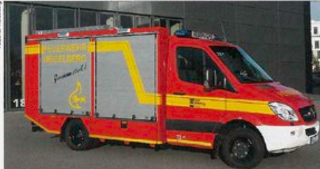
Multifunktionsleuchten: Die zwei auf dem Dach vorinstallierten Leuchten können mit einer öldruckgedämpften Absenkung ohne Betreten des Dachs entnommen werden.
