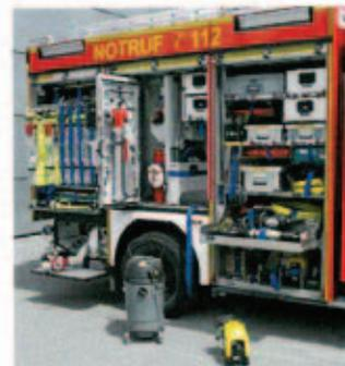
Anstelle des hydraulischen Aggregates sind zwei tragbare Kompaktaggregate verlastet. Im G4 ist der Auszug mit der entnehmbaren „Trageeinheit Wasserentnahme Hydrantenetz“ zu sehen. Foto: Feuerwehr Heidelberg
