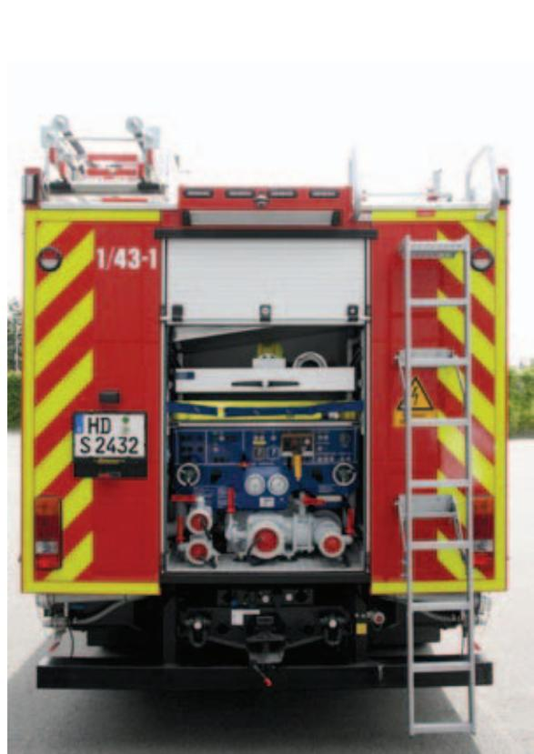
Der Pumpenbedienstand entspricht dem TLF3000, was eine fahrzeugübergreifende, einheitliche Bedienung ermöglicht.
