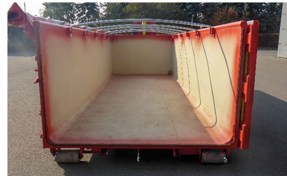
Heck mit geöffneten Schwenktüren Die weit öffnenden Flügeltüren erleichtern das Beladen
