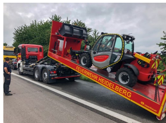
Mittels Abrollbehälter wurde der Teleskopstapler zur Einsatzstelle gebracht
