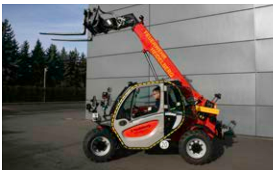
Die maximale Hebekraft beträgt 2,5 Tonnen
