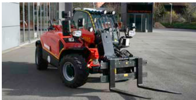
Der Hubarm erreicht eine Arbeitshöhe von knapp 6 Meter
