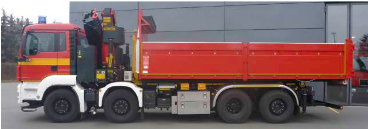
Mit dem Kran des Wechselladers können auch Paletten geladen bzw. entladen werden
