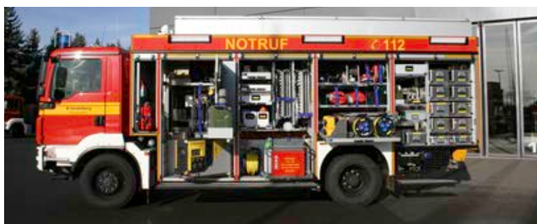
Ausklappbare und ausschwenkbare Halterungen erleichtern die Entnahme der Ausrüstung
