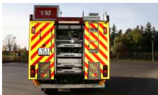
Die auffällige, reflektierende Heckbeklebung erhöht die Wahrnehmung des Fahrzeuges
