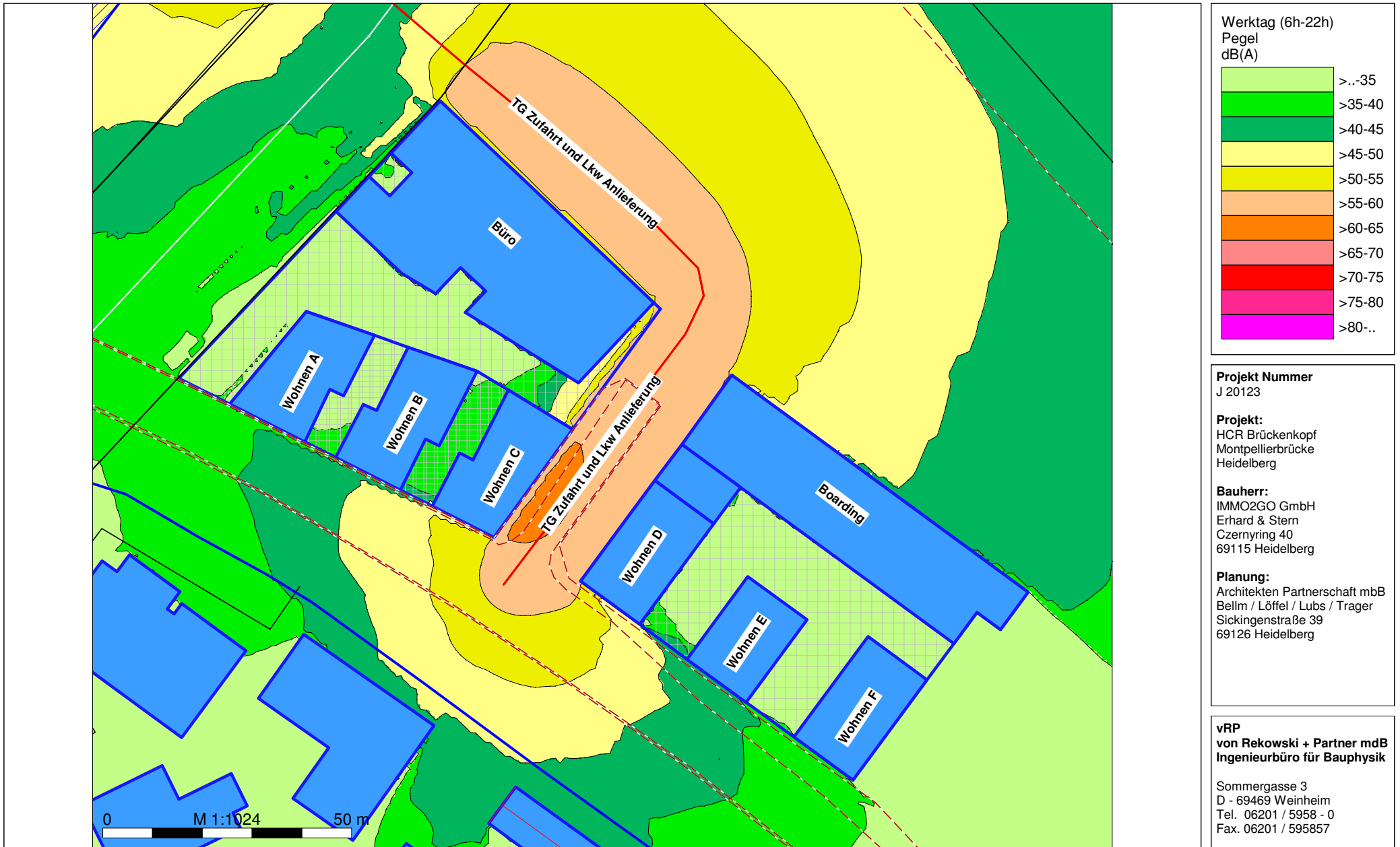
Anhang 5.3 - Tagzeitraum Beurteilungspegel aus dem vom Plangebiet ausgehenden Geräuschen nach TA Lärm in Höhe Erdgeschoss
