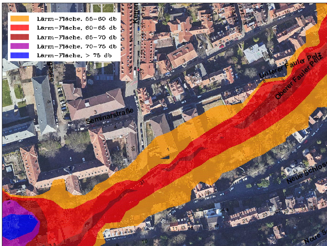
Lärmkartierung 2017 – Lärmindex Straßen (24h), Quelle GTIS Stadt Heidelberg
