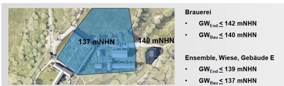
Abbildung 30: Bemessungsgrundwasserstände
