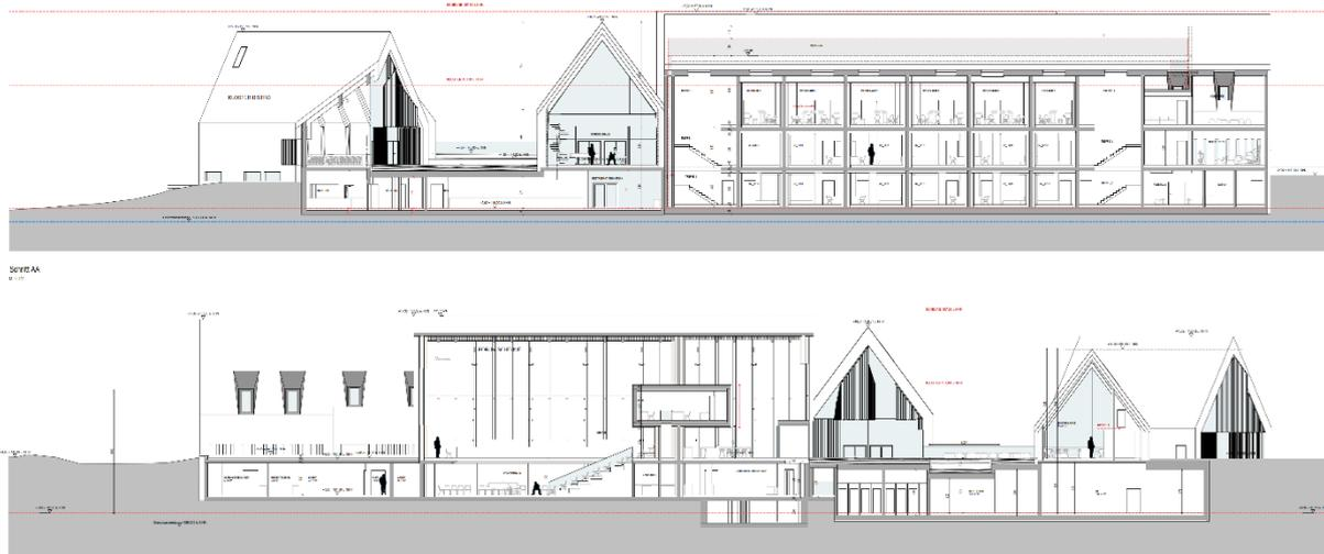
Abbildung 15: Ensemble Längsschnitt A und B [U 1.1]
