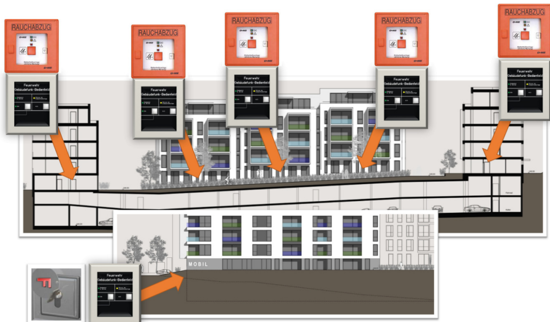
Abbildung 1: Prinzipskizze zur Positionierung von Feuerwehr-Gebäudefunkbedienfeldern Bildquelle: Pielok Marquardt Planungsgesellschaft mbH; Offenbach
