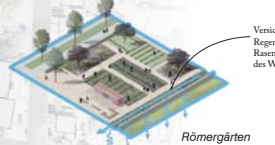
Versickerung des Regenwassers in Rasenmulden + Verwendung des Wasser zum Gießen
